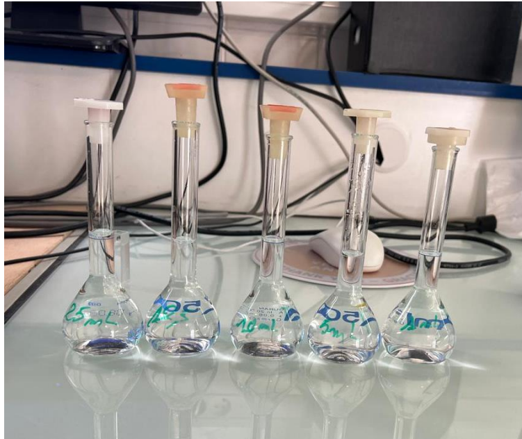
Préparation d'une gamme de solutions de toluène F(2;4;5;10;50)
